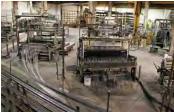
Una de las esquinas de la planta Twin City Wire en Eagan, MN, muestra cinco telares de malla de alambre en operación.
